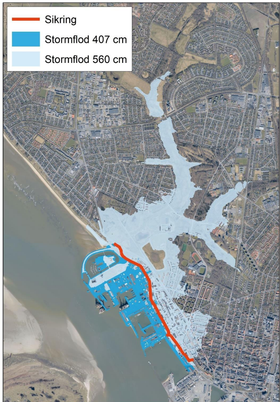
Figur 2-5 I analysen er der fokuseret på de skader der ligger bag sikringslinjen. Da Esbjerg Havn, via egen beredskabsplan og lokal sikring af bygninger, aktivt har reduceret deres risiko, ses der således på skadesbilledet øst for den tiltænkte sikring (indtegnet med rødt). Her vist en lav og en høj vandstand som i beregningsmetoden over tid ændrer sandsynlighed i takt med stigningen i middelvandspejlet.
