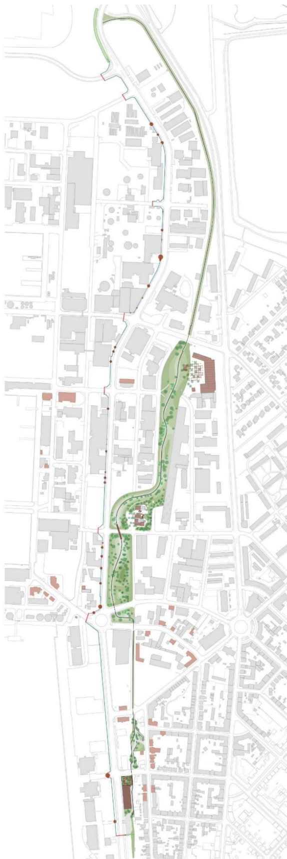
Figur 3-3 Visning af Fase 1 "Højvandsmuren" (tv) og Fase 2 "Havnestrøget" (th). Fase 1 er en lav mur og Fase 2 er korridor med varierende anlægsbredde indpasset i byrum.
