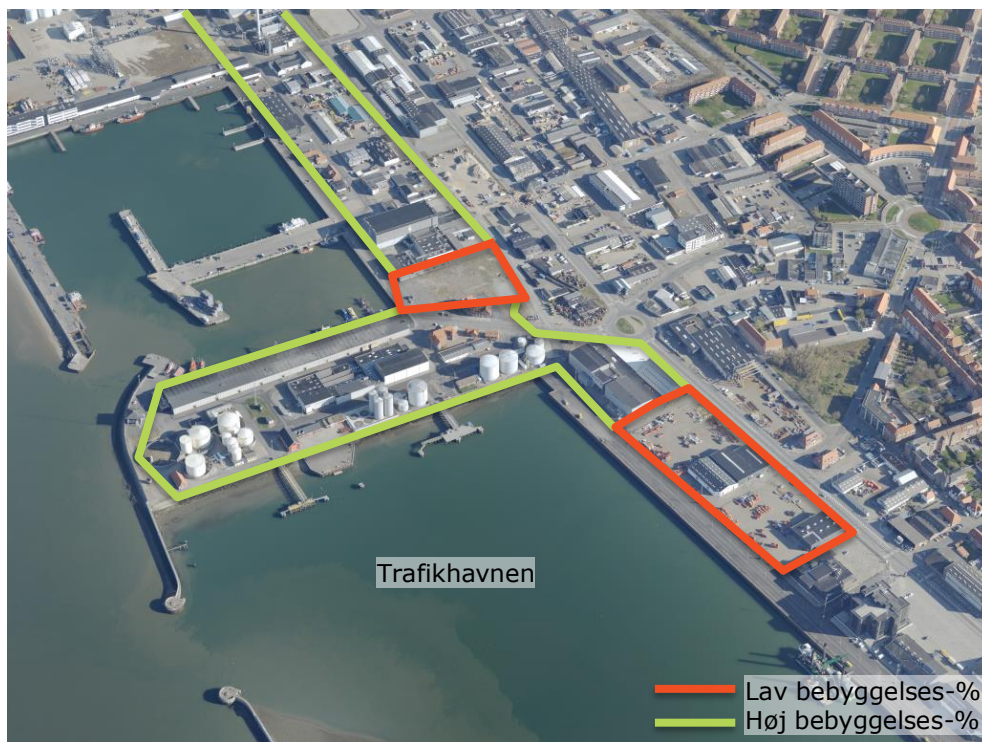
Figur 4-7 Områder med høj og lav bebyggelsesprocent foran sikringen. I områder uden sammenhængende bebyggelse foran sikringen, vil bølgeeksponeringen være størst under stormflod.
