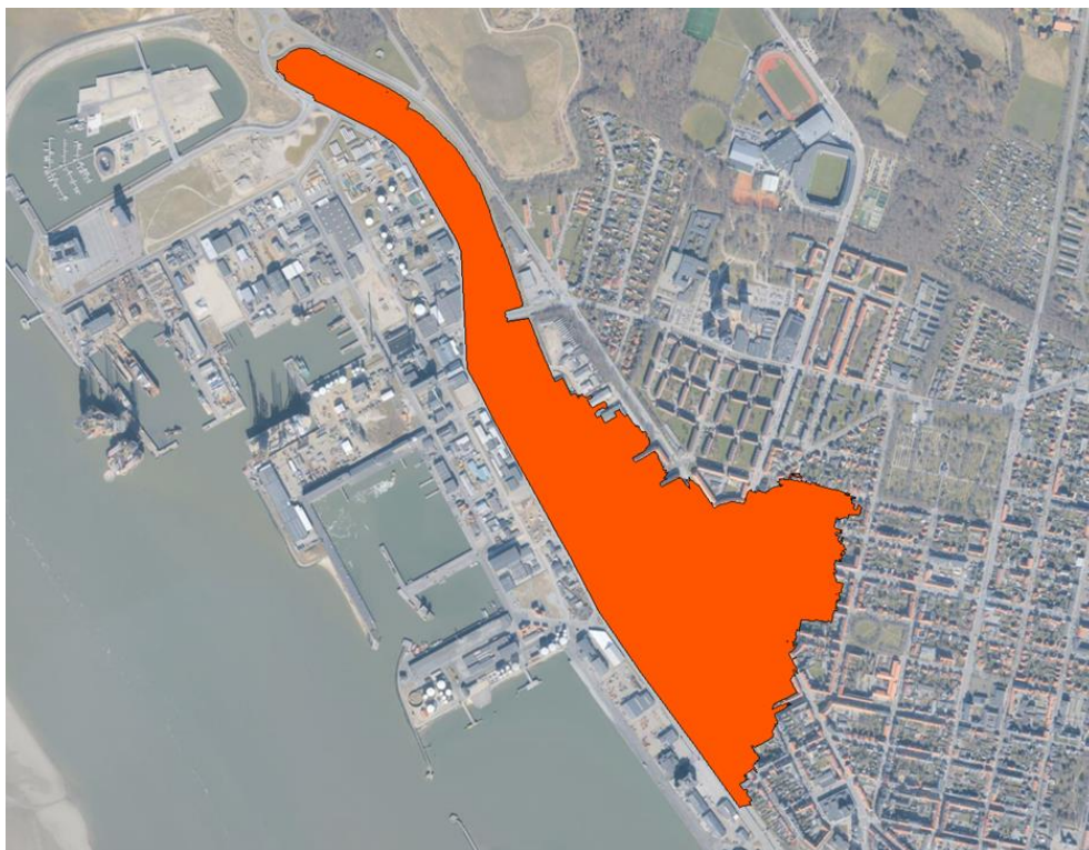
Figur 4-3 Visning af hvad der beskyttes ved implementering af Fase 1. Højvandsmuren til kote +4,8 m.
