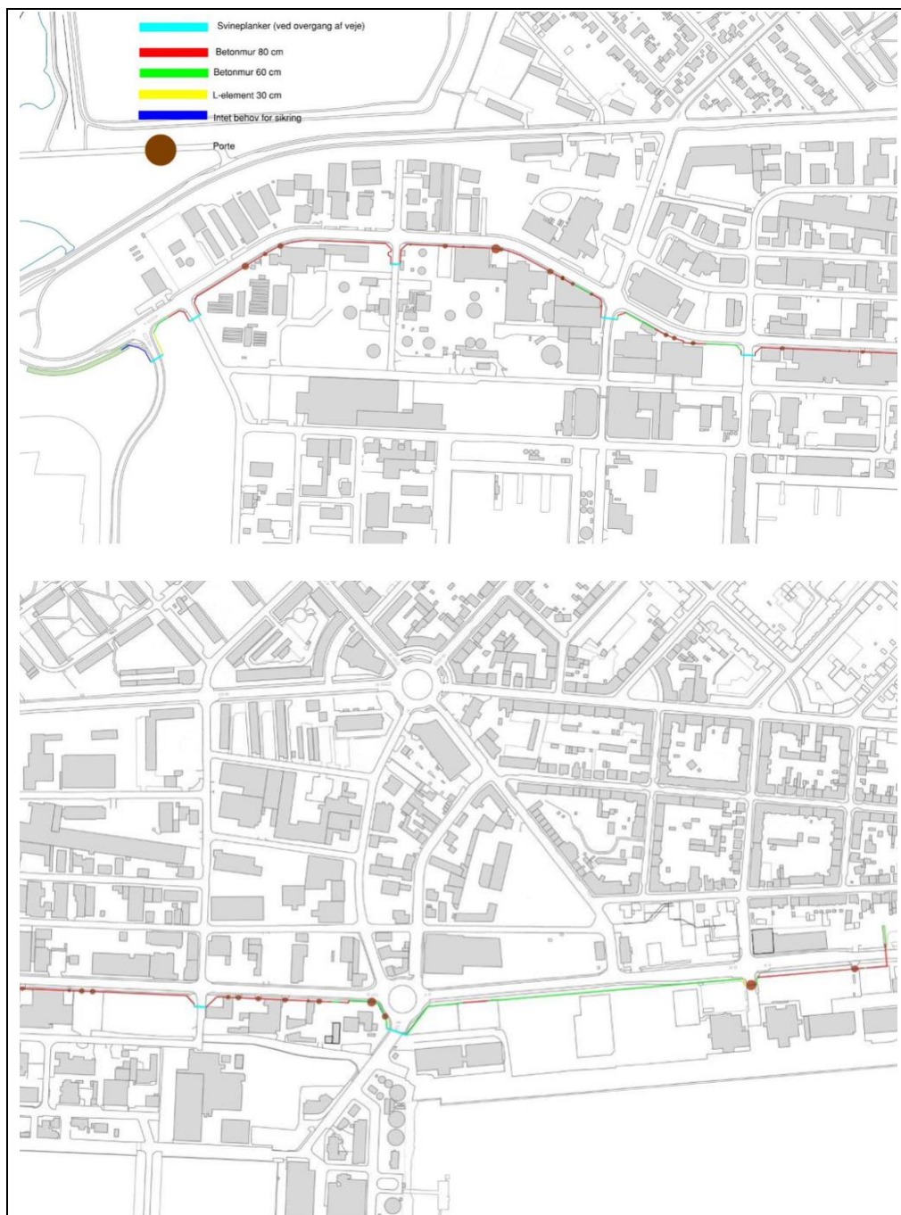
Figur 4-24 Fase 1 "Højvandsmuren" delkomponenter i anlægsoverslaget.
