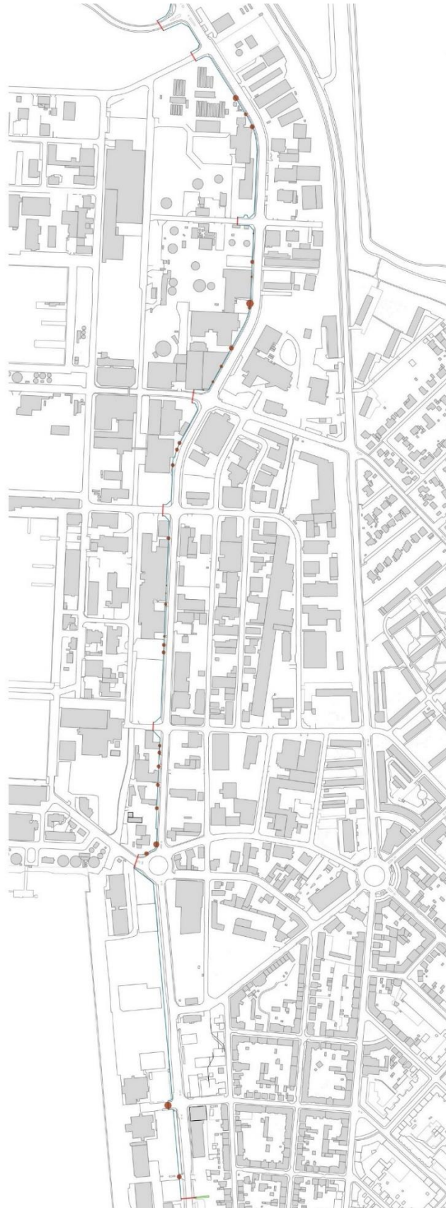
Figur 4-1 Visning af Fase 1 "Højvandsmuren" forløb og karakteristik langs Adgangsvejen og H E Bluhmes Vej. De røde prikker og røde streger indikerer, hvor der er åbninger, som skal håndteres med enten porte eller svinerygsplan-ker.
